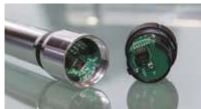
電子元件整合在打氣筒的底部，具備生活防水。
