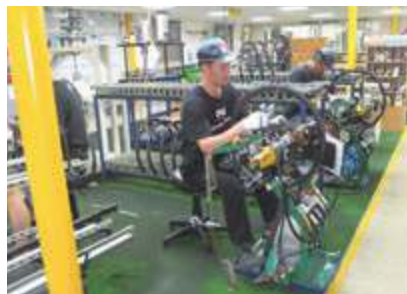
JoytechではFactorホイールの初期製造工程を自動化しているが、熟練工がホイールの許容誤差を念入りに調整していく。
